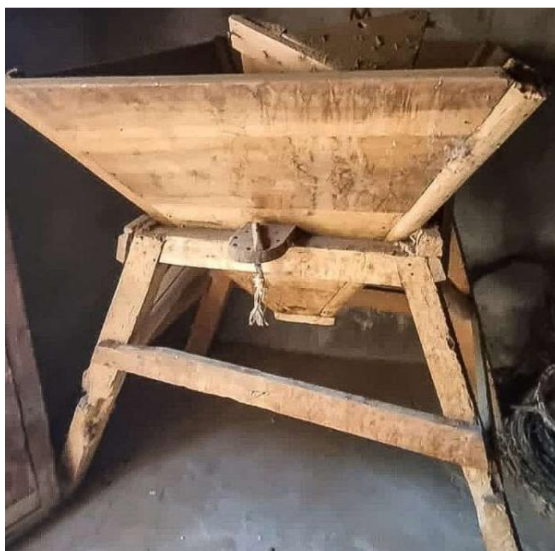
Figura 3: Tolva del molino hidráulico harinero. Pisquera Bou Barroeta, Huasco. Foto: RB.
