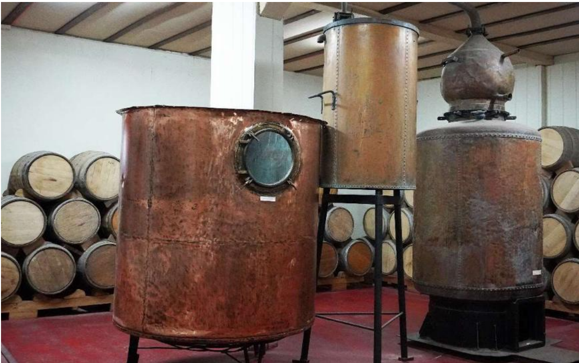
Figura 3. Alambique de cobre labrado. Cooperativa Control, Ovalle. Foto: AKB.
